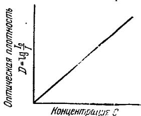
Рис. 102. Калибровочная кривая зависимости оптической плотности от концентрации окрашенного вещества.
